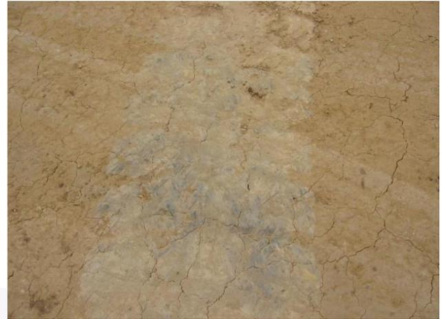
**Remediación de Suelos Dispersivos** - Estabilizar sub rasantes altamente sódicas. Incrementa la fuerza y la resistencia al agua y reduce el desgaste y la erosión de la superficie a través de la floculación de partículas finas - Origin Energy
